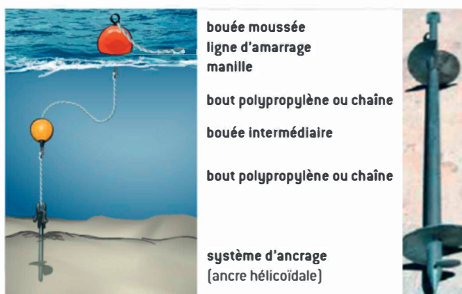
Exemple : ancre à vis « Screw » (photo à droite)
