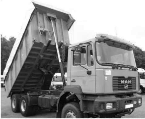
Camion benne 6x4 de l'entreprise
